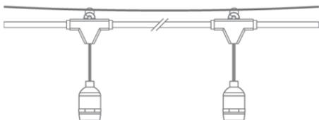
PASSO 2. Faça a instalação das lâmpadas nos soquetes e rosqueie até que o corpo encoste no anel de vedação. Confira se a tampa de vedação ao final do conjunto está bem firme.
