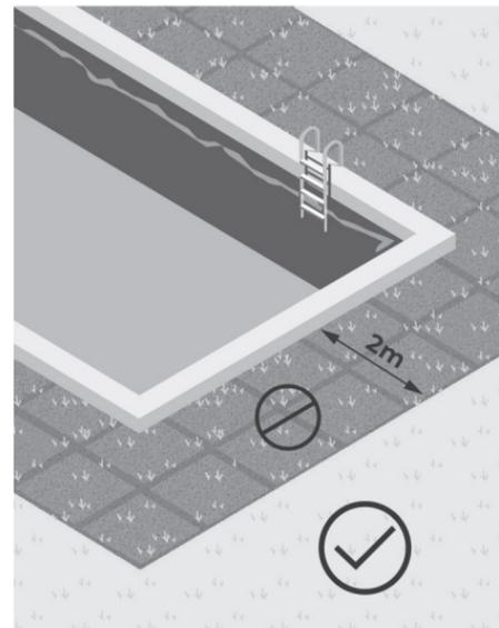
Não instale próximo a reservatórios de água, como piscinas, fontes, entre outros. Respeite a distância mínima de 2 metros, de acordo com a NBR 5410.
